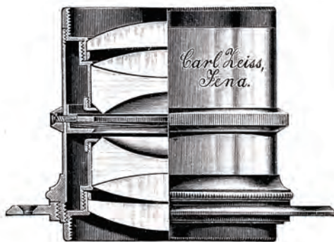
Fig. 5. Serie Ia No. 11. Planar 1 : 3.8 f = 160 mm. (In ca. \frac{2}{3} natürl. Grösse.)
